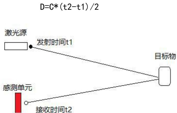
经过 N10 系列激光雷达内嵌的信号处理单元的实时解算得到探测物体的距离值，结合高精度自适应角度测量模块输出的角度信息，可以得到量程内周围 360 度环境的二维平面信息。
