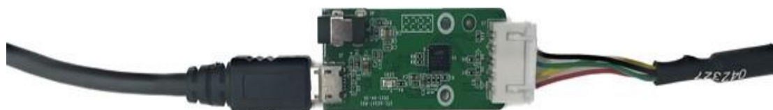
图表 2-2 连接 USB 转接器与 Micro-USB 实物图
